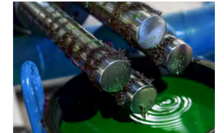
Магнитная вставка в механическом фильтре эффективно собирает остатки продуктов коррозии из сетевой воды.
