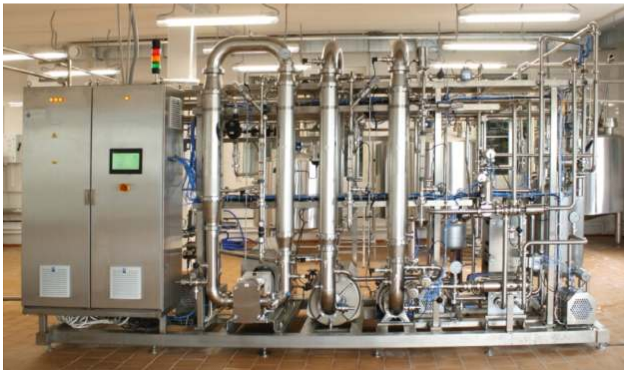
Установка марки "ВОДОПАД УТК 12,95-3-47", 250 кг творога в час из коровьего и козьего молока; ОАО "Сернурский сырзавод"; эксплуатируется с 2015г.
