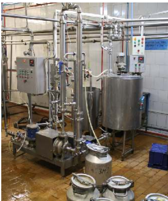
Установка марки "ВОДОПАД УТК 2,5-2-8", 80 кг творога в час; Московская область, г. Наро-Фоминск, ОАО "Молочный завод "Наро-Фоминский"; эксплуатируется с 2004 г.
