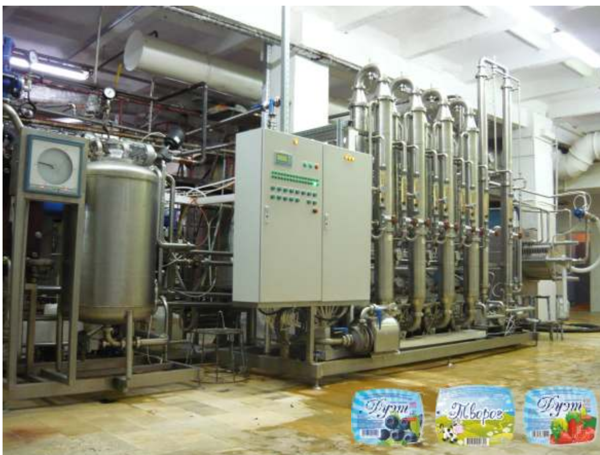
Установка марки "ВОДОПАД МТК 48,9-5-173", 970 кг творога в час; г. Каменск-Уральский, ОАО "Молоко"; эксплуатируется с 2008 г.
