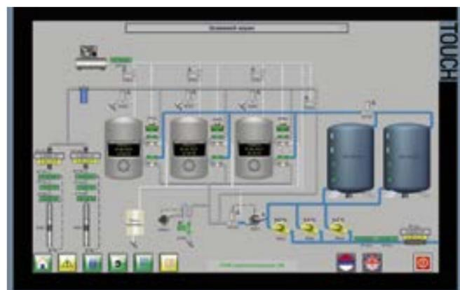
В ряде случаев возникает необходимость в использовании передвижных станций очистки воды. Решение водоподготовки состоит из нескольких шагов: фильтрация, умягчение и деминерализация - все это регулируется центральным шкафом управления. Такая станция должна быть собрана на заводе EUROWATER.
